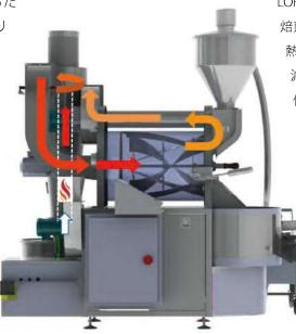
LORING 特許のシングルバーナー技術は、 焙煎中の CO<sub>2</sub>の削減、消煙、そして循環 熱風システムはエネルギーコストの削 減を実現。アフターバーナーの機能も 備えるため、通常ならメインバーナー の 400% 以上の火力が必要なアフター バーナーが不要です。これにより最大 80% のエネルギーコストの削減が可 能で、同時に CO<sub>2</sub>の抑制にも寄与し、 地球環境にとても優しい焙煎機
