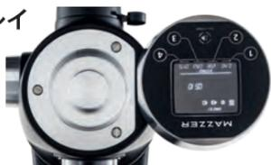
マイナスネジ3点を取り外し、チャンバーを引き抜く事で、容易にディスクを取り出す事が可能に。定期的なディスク清掃や、ディスク交換が容易に行えます。
