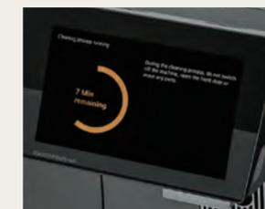
コーヒー豆・牛乳の補充のお知らせ、マシンの清掃等、各種オペレーションをディスプレイに表示。アニメーションに従いながら、わずか数ステップで自動洗浄が行えます。
