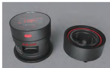
AW-600は、生豆内の細菌の成長状態を予測するために使用し、サンプルからテストチャンバーにかかる蒸気によって、水分活性値を測定します。測定モードは、クイックモード・平衡モードとなります。
